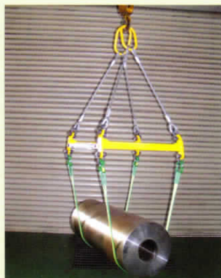
吊り天秤(4点吊り)
