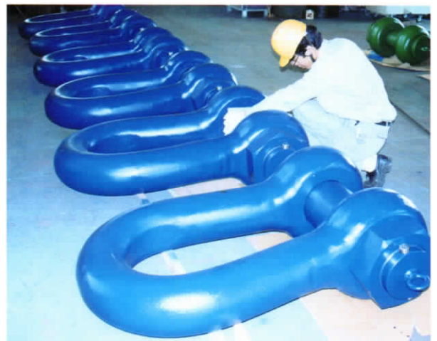
▲ 使用荷重800トン、世界最大級の鍛造シャックル
