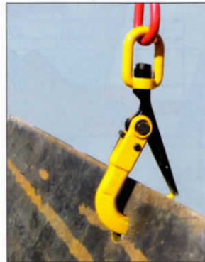
●敷鉄板の敷設・撤去作業
