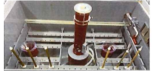
塩水噴霧機内の試験体
